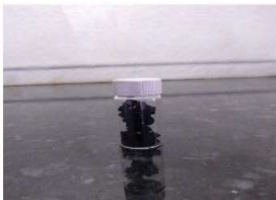
Figura 31: morfologia macroscópica aglomerada de MWCNTs- HNO_3 .
