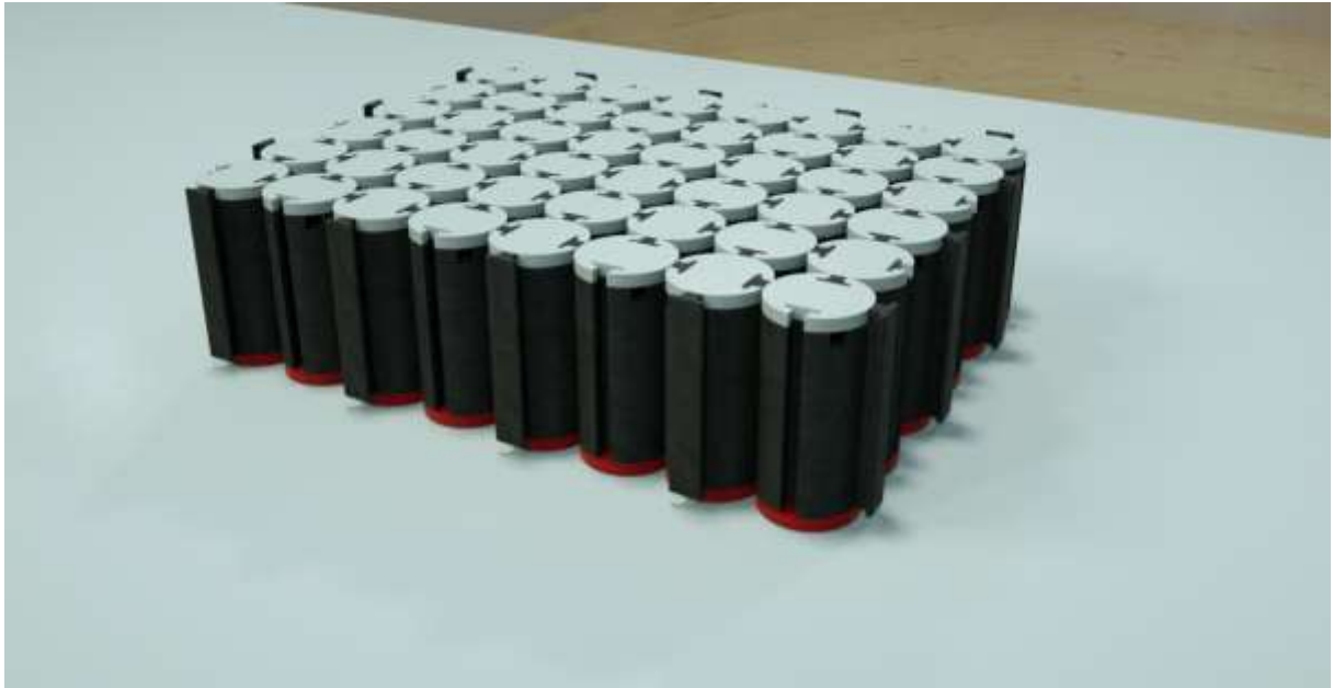
Figura 40: junção de 35 pilhas com suporte em "T", formando uma bateria.
