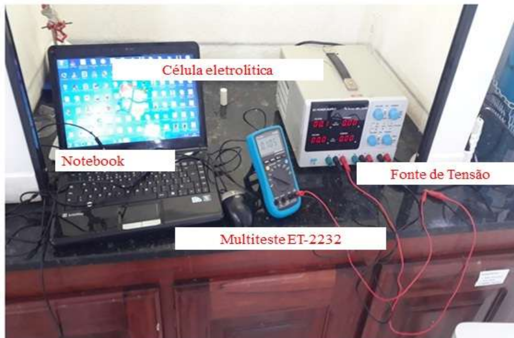
Figura 27: Circuito montado para aferição da tensão de circuito aberto
