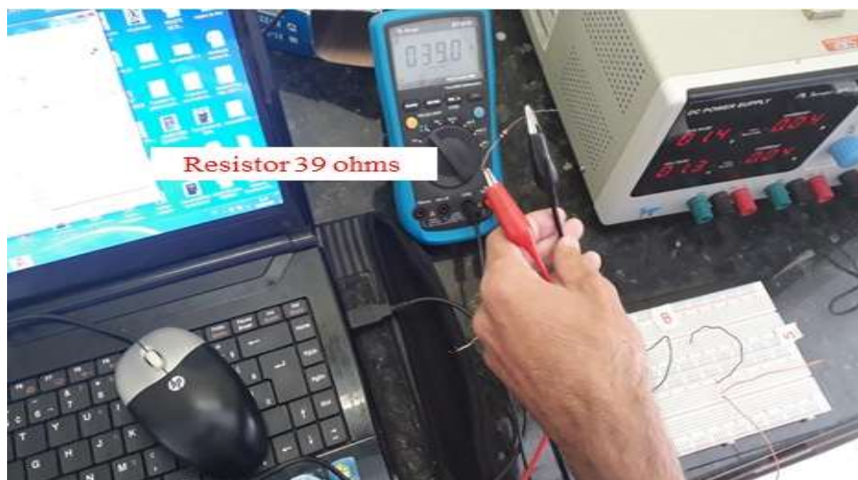
Figura 29: Multitest ET 2232 com o resistor de 39\Omega .
