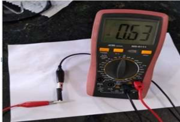
Figura 35: medição da resistência com a colagem do buckypaper.
