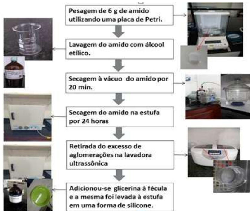
Figura 22: Processo de preparação dos filmes de amido.
