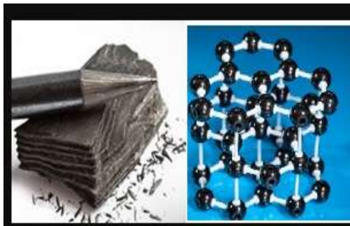
Figura 05: Estrutura hexagonal da forma alotrópica do carbono grafite, bem como uma de suas aplicações lápis.
