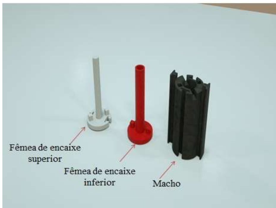
Figura 39: invólucro da célula eletrolítica em forma final
