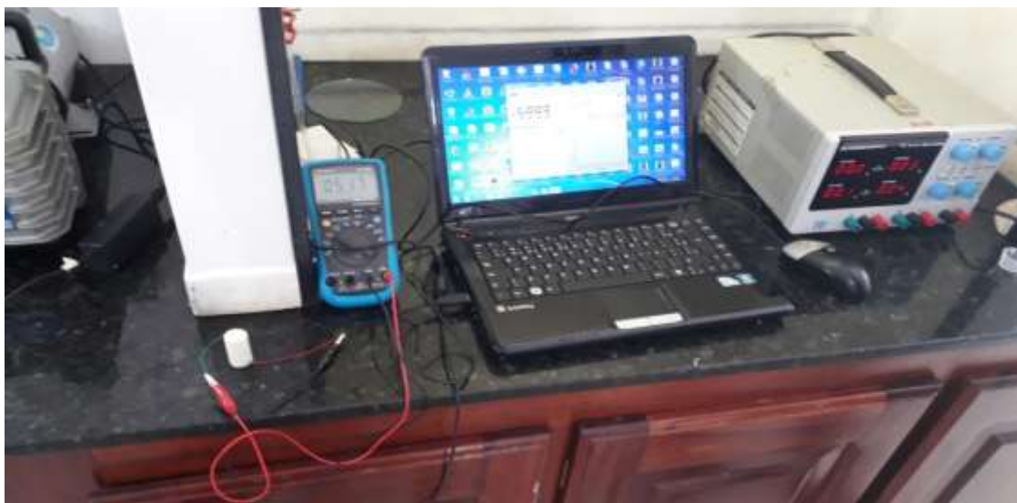
Figura 43: tensão residual de 51.7 mV na célula eletrolítica.
