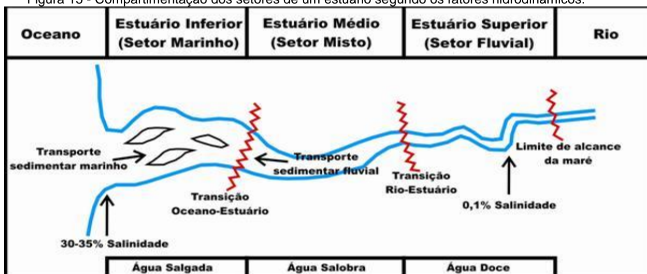
Figura 15 - Compartimentação dos setores de um estuário segundo os fatores hidrodinâmicos.
