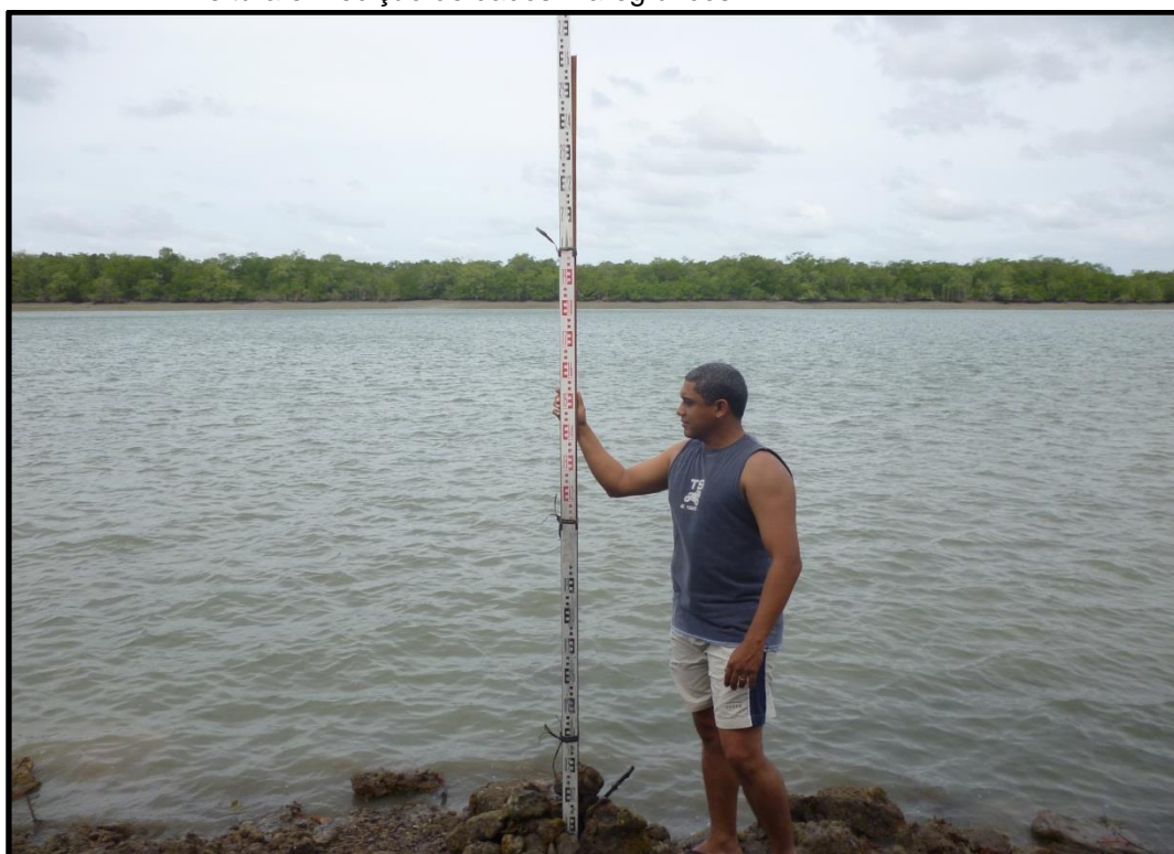
Figura 23 - Régua graduada instalada em frente ao trapiche da Fazenda São Paulo para a leitura e medição de dados mareográficos.
