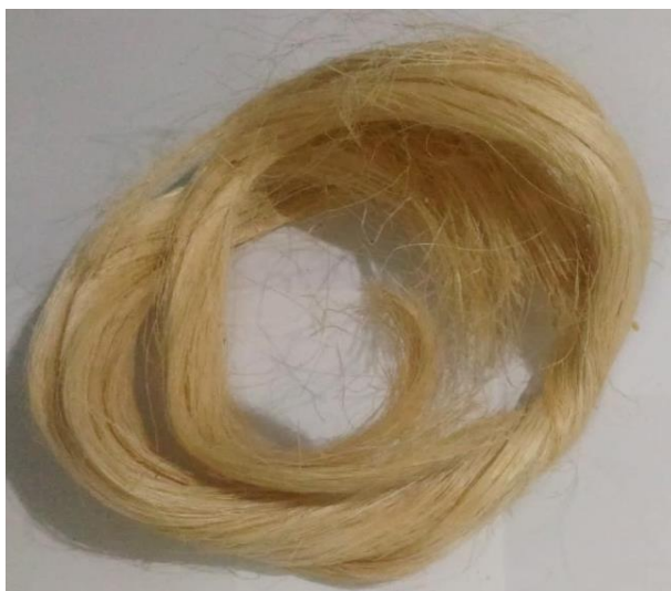
Figura 16 - Fibra de sisal fornecida pela empresa SISALSUL
