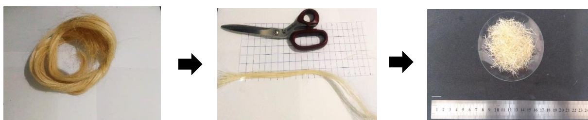
Figura 18 - Processo de corte das fibras de sisal
