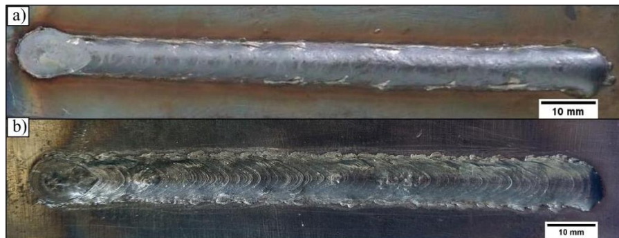
Figura 8 - Cordões de solda: a) Sem a técnica de switchback; b) com a técnica de switchback com avanço 4 e reversão 2
