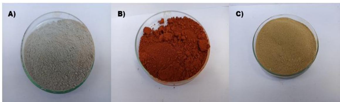
Figura 10 – Matérias primas beneficiadas: A) Sílica; B) Resíduo da bauxita; C) Argila.
