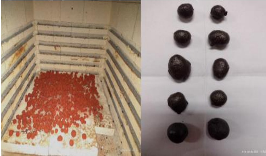
Figura 13 – Agregados antes do processo de sinterização e após.
