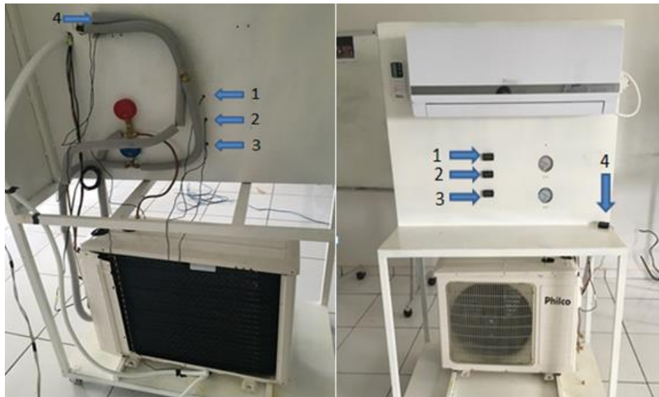
Figura 35. (A) Localização dos termômetros na parte de trás; (B) Localização dos termômetros na parte da frente.
