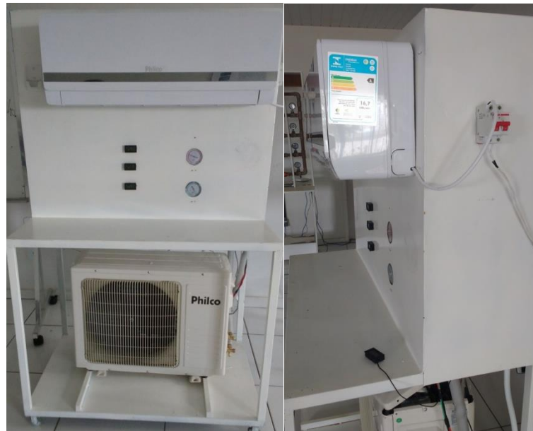
Figura 32. (A) Implantação dos elementos na estrutura metálica (B) Implantação do disjuntor na lateral da estrutura.
