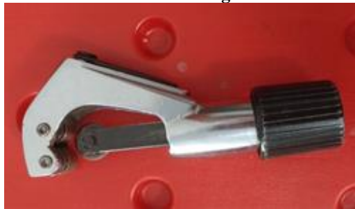
Figura 24. Ferramenta de corte e flangeamento de tubulação.
