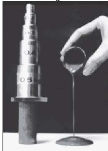
Figura 6: argila de alta sensibilidade, a direita no estado indeformado; e, a esquerda, no estado amolgado
