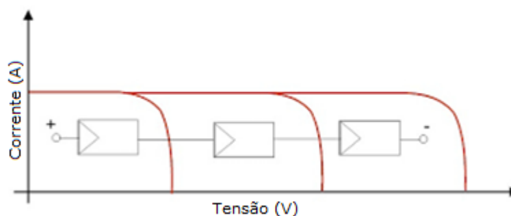
Figura 13 – Ligação dos módulos em série
