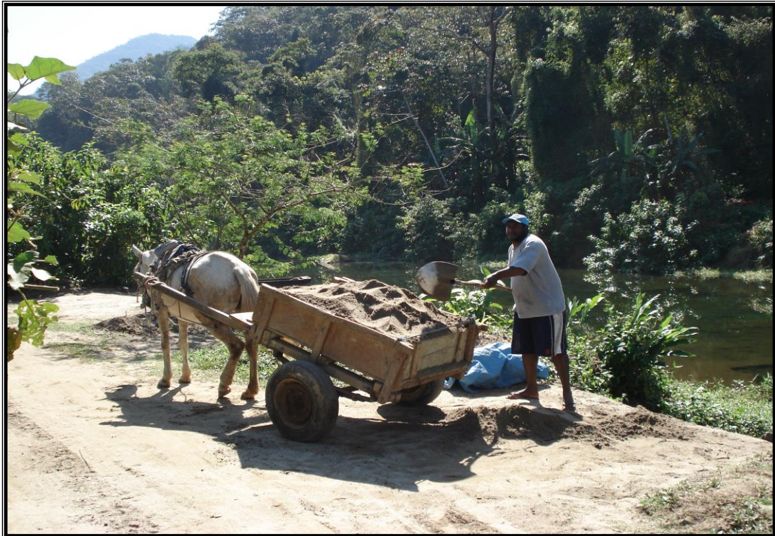
Figura 2 - Lavra por escavação por meio de pás. Fonte: Bauermeister, 2007
