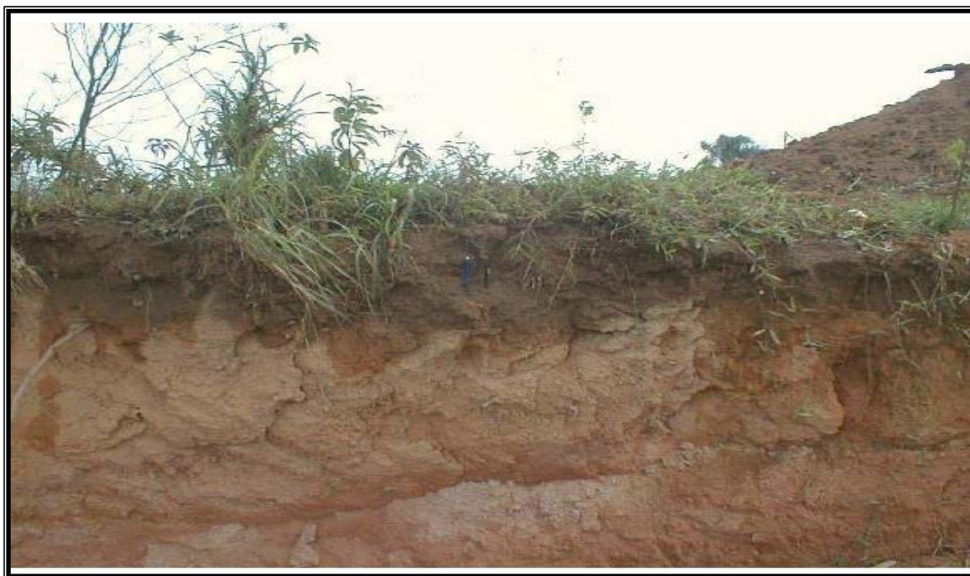
Figura 9 – Perfil do solo onde se distingue a camada orgânica e a argilosa.
