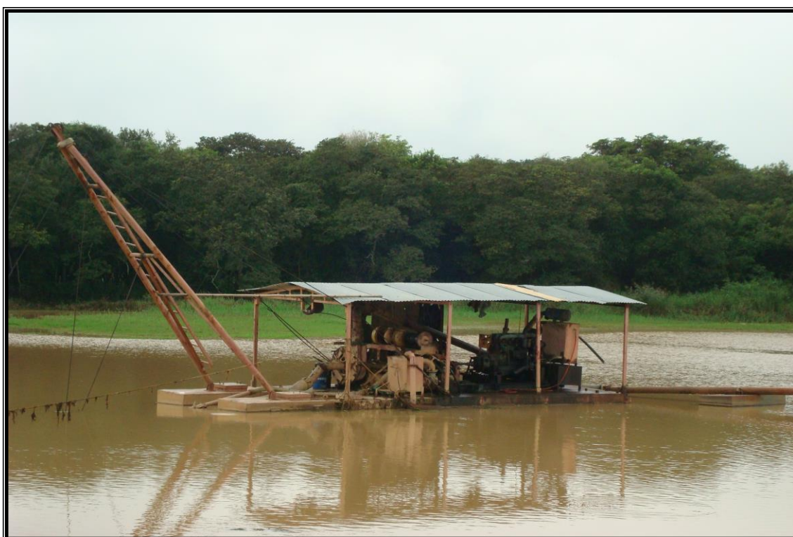
Figura 6 - Lavra por dragagem em leito de rio ou cava submersa. Fonte: Bauermeister, 2008.
