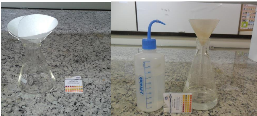
Figura 17- Produto da síntese sendo lavado até pH neutro
