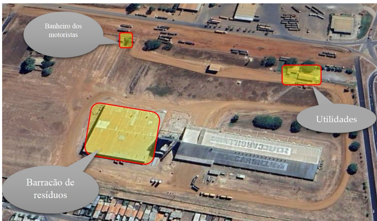
Figura 15 – Locais para instalação de SPDA externo
