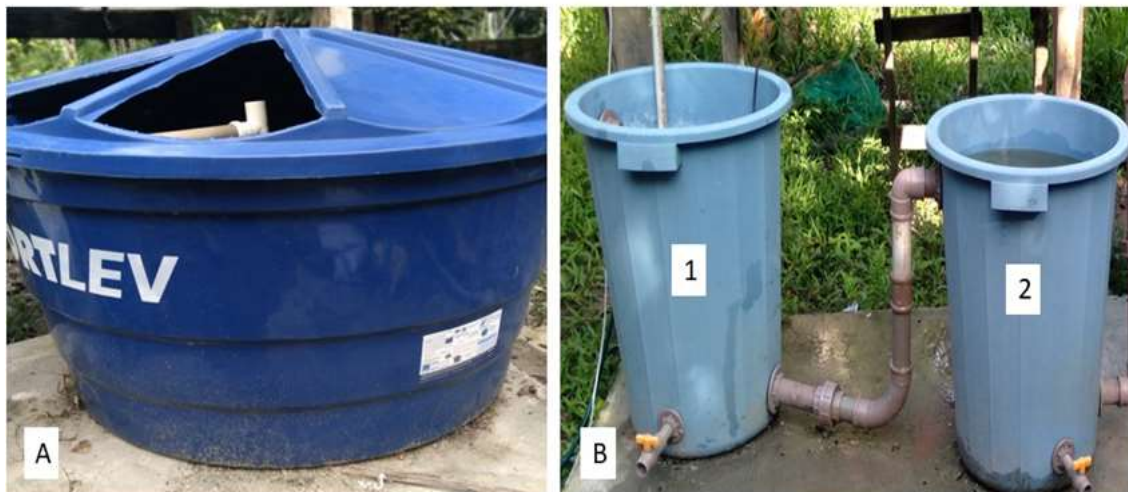
Figura 5- A- Caixa d'água de 1000 litros usada como tanque de criação dos peixes no sistema aquapônico; B-conjunto de filtragem composto por um balde filtro (1) e um balde decantador (2), ambos com capacidade para 100 litros de água.
