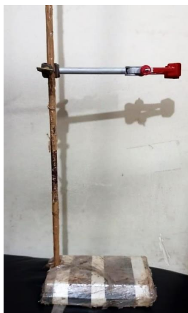
Figura 3.8 – Aparato metálico utilizado nos testes de flamabilidade
