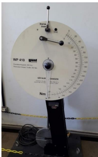
Figura 3.6 – Equipamento utilizado para o ensaio de impacto
