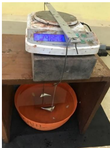
Figura 3.5 – Aparato utilizado para obtenção da massa imersa
