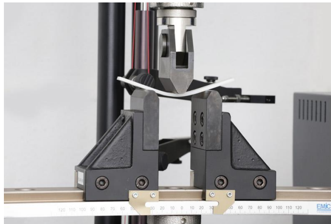
Figura 4 – Ensaio de flexão em 3 pontos.
