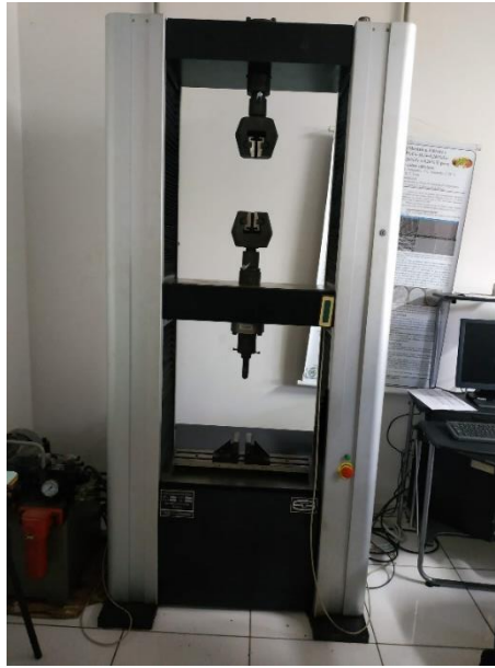
Figura 20 – Máquina utilizada para o ensaio de flexão.
