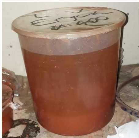
Figura 13 – Resíduo de lama vermelha peneirado à úmido.
