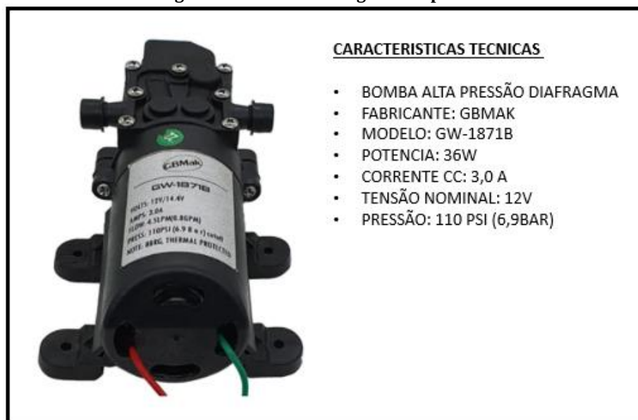
Figura 11. Bomba diafragma alta pressão.
