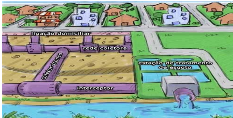
Imagem 16– Sistema de coleta de esgoto
