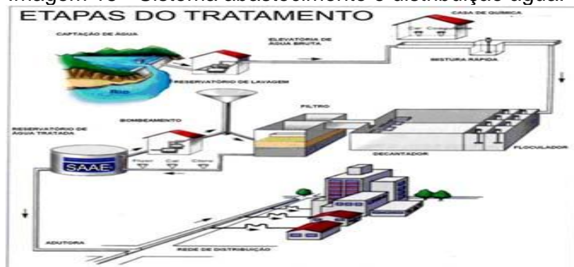
Imagem 15 - Sistema abastecimento e distribuição água.
