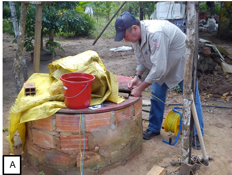
Figura 57 – Medição do nível estático nos poços 15 (A) e 14 (B).
