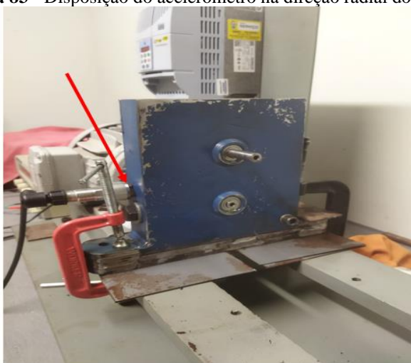
Figura 83 - Disposição do acelerômetro na direção radial do pinhão.
