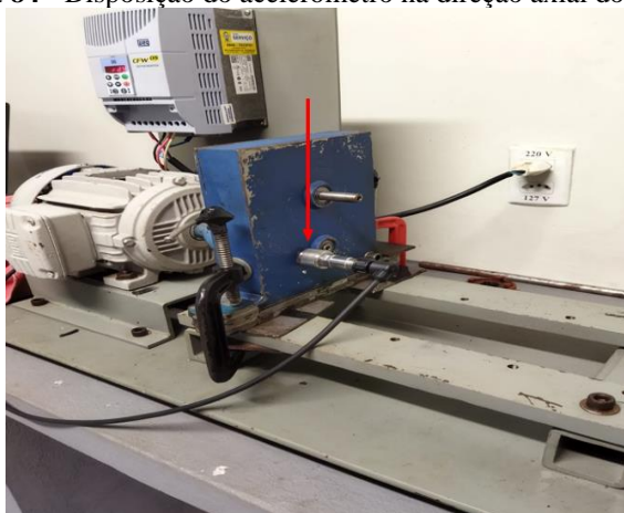
Figura 84 - Disposição do acelerômetro na direção axial do pinhão.
