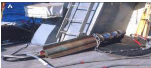
Figura 17 – Airgun de pequeno porte usado em levantamentos sísmicos de alta resolução.
