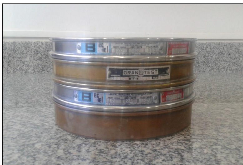
Figura 10 - Conjunto de peneiras utilizado para a separação granulométrica.
