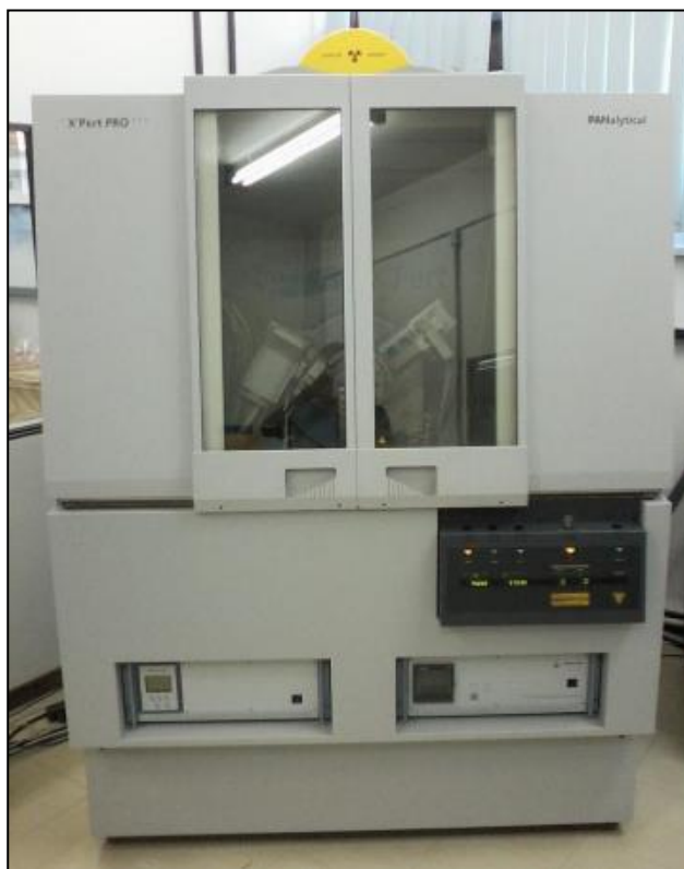
Figura 13 - Difratorômetro de raio-X, utilizado na identificação dos minerais presentes na amostra.
