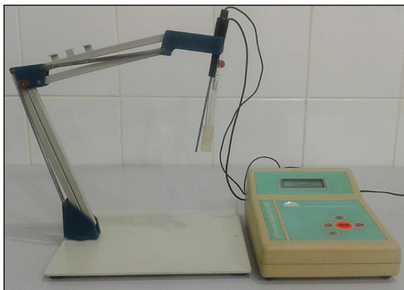
Figura 9 - pHmetro utilizado para análise do pH.
