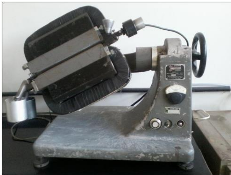
Figura 12 - Isodynamic Frantz, utilizado para fazer a separação magnética do concentrado.
