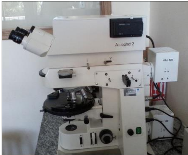
Figura 15 - Microscópio óptico de luz refletida, utilizado para descrever as seções polidas.
