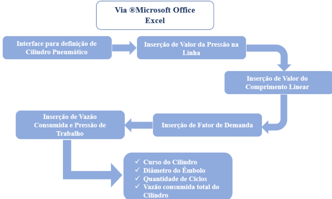
Figura 8. Fluxograma de seguimento para cilindro pneumático (via software @MS Excel).
