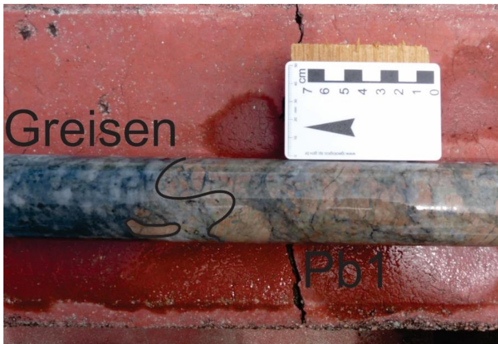
Figura 14- Testemunho de sondagem percussiva diamantada, do maciço Pedra Branca, em destaque para o contato do greisen mineralizado, com o biotita granito Pb1 (Fonte: Autor).
