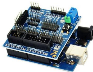
Figura 2 - Sensor Shield posicionado sobre a placa de Arduino UNO.
