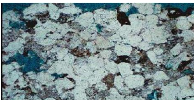
Figura 25 - Diferença de meios porosos: um arenito convencional em A e um arenito compactado, não convencional, em B, nos quais a coloração azulada denota o espaço poroso da rocha. Fonte: Virgens (2011).
