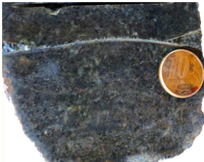
Figura 17 – Amostra de campo de um anfibolito típico da área de estudo (Ponto MC-122). Detalhe das vênulas preenchidas por plagioclásio.
