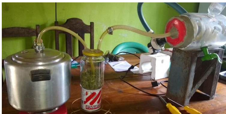
Figura 22 - Conexão das três partes (mini caldeira, condensador e coluna de destilação).
