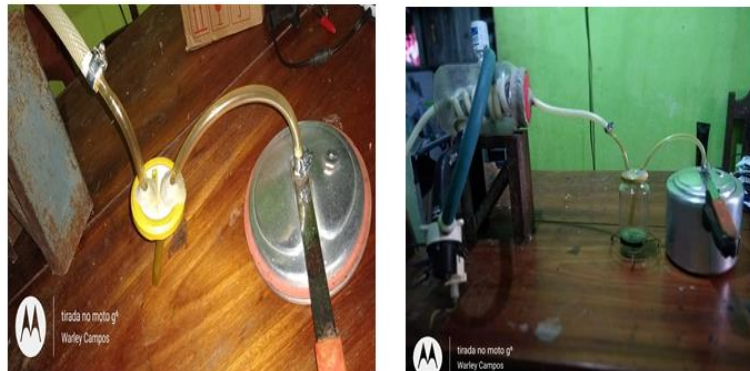
Figura 21 - Segunda conexão entre condensador e mangueira da coluna de destilação.
