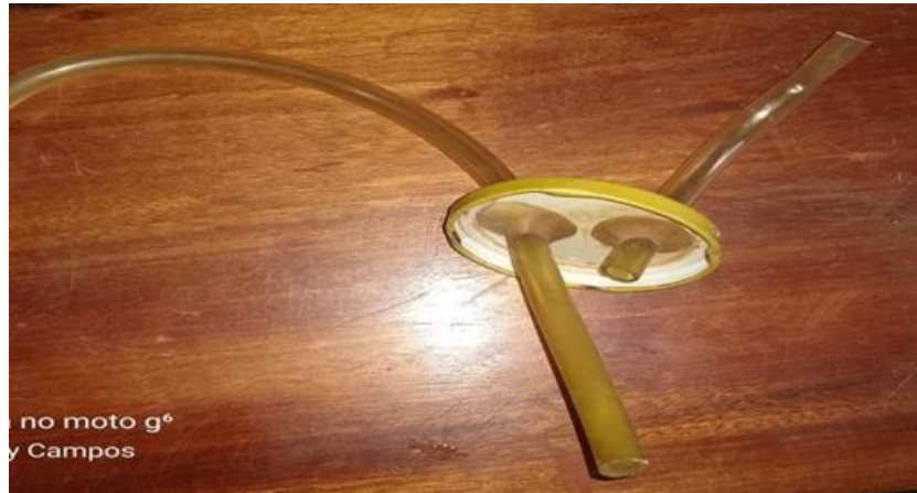
Figura 14 - Demonstração de como a tampa da coluna de destilação e as mangueiras devem ficar.
