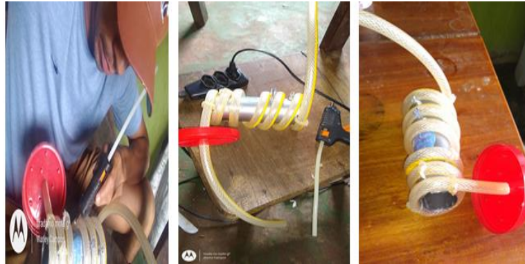
Figura 17 - Construção da serpentina (peça G)
