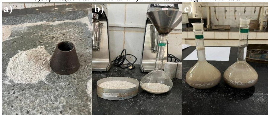
Figura 12 - Etapas finais do ensaio de densidade de massa e absorção de água: a)molde cônico, b)separação das amostras e c)amostras com água destilada
