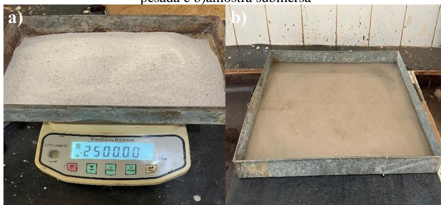
Figura 10 – Etapas iniciais do ensaio de densidade de massa e absorção de água da areia: a) amostra pesada e b) amostra submersa
