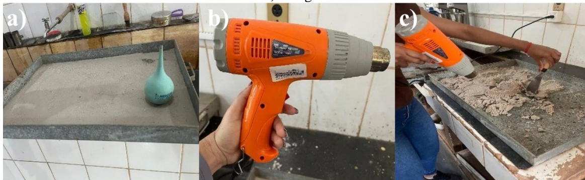
Figura 11 – Processo Secagem da areia: a)remoção da água por sucção, b)soprador térmico utilizado e c) secagem
