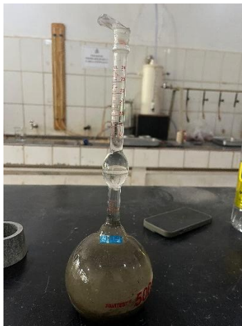
Figura 14 - Leitura do volume final da amostra de cimento com querosene
