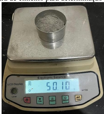
Figura 13 - Amostra de cimento para determinação do índice de finura
