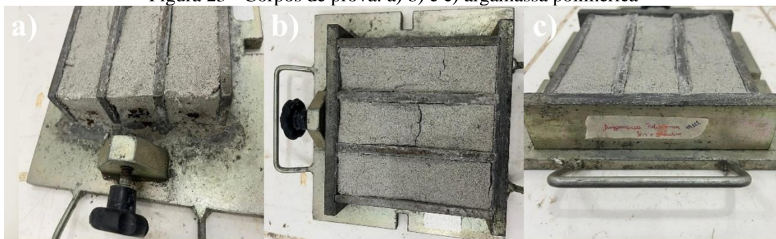
Figura 23 - Corpos de prova: a) b) e c) argamassa polimérica
