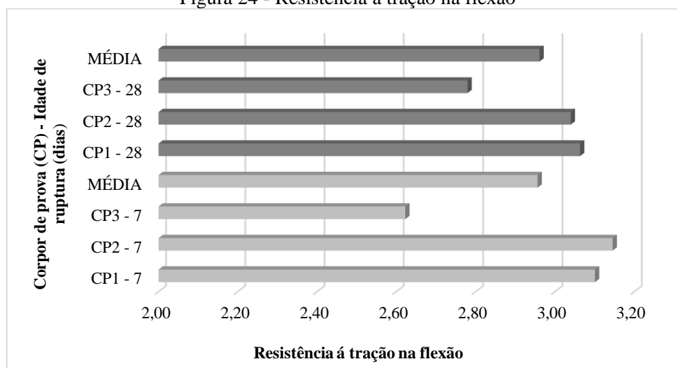
Figura 24 - Resistência a tração na flexão
