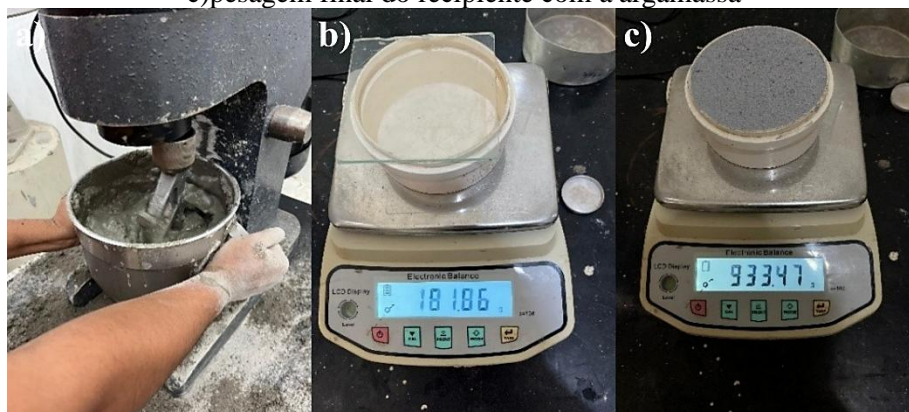
Figura 16 - Ensaio de densidade de massa: a) preparo da argamassa, b) pesagem inicial do recipiente e c) pesagem final do recipiente com a argamassa
