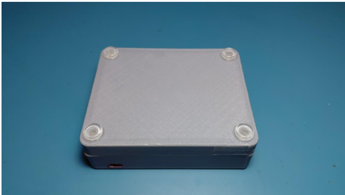
Figura T.6 – Vista traseira do protótipo final, contemplando pés antiderrapantes/antichoque.
