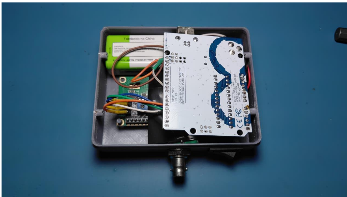
Figura T.2 – Vista frontal do circuito do protótipo de pH acondicionado no invólucro sem tampa.
