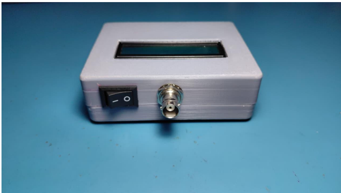
Figura T.3 - Vista superior do protótipo final, contemplando o LCD, interruptor e o conector da sonda de pH (ou saída do sensor DS18B20 no caso do protótipo de temperatura)
