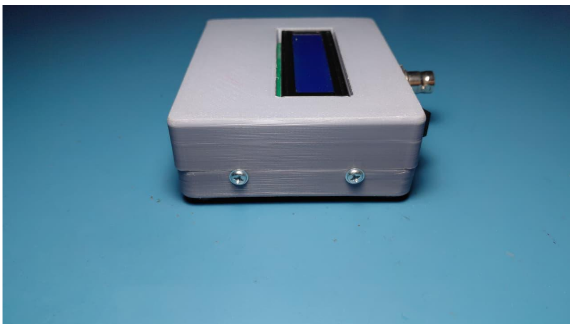
Figura T.4 – Vista lateral do protótipo final, contemplando os parafusos que mantêm o invólucro fechado.
