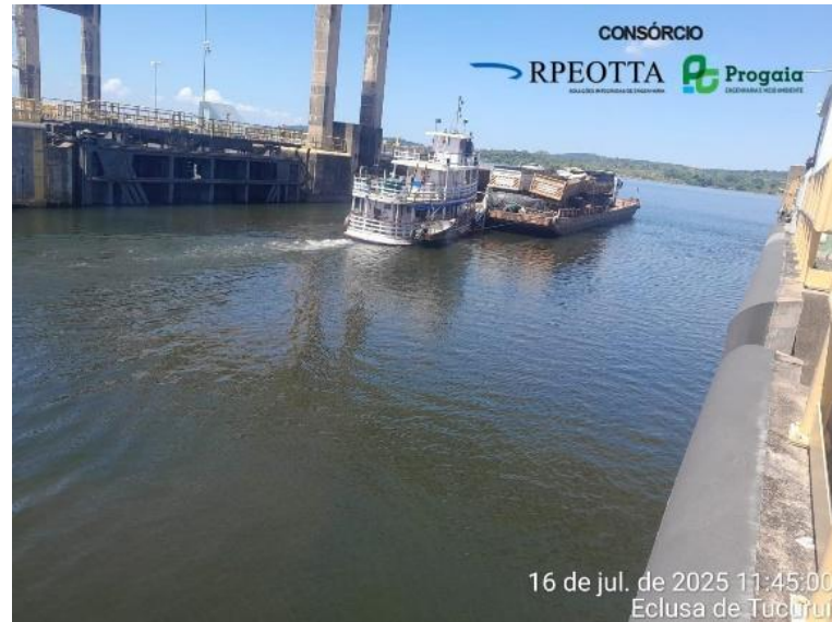
Figura 45 - Saída do comboio da câmara principal e término da transposição - Eclusa 1
