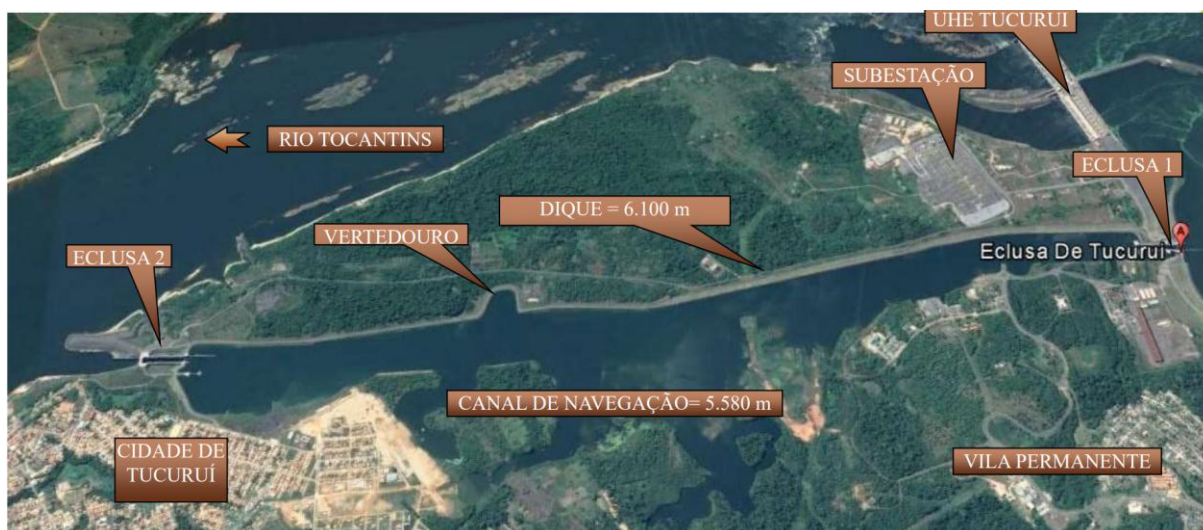
Figura 3 - Arranjo geral do sistema de transposição
