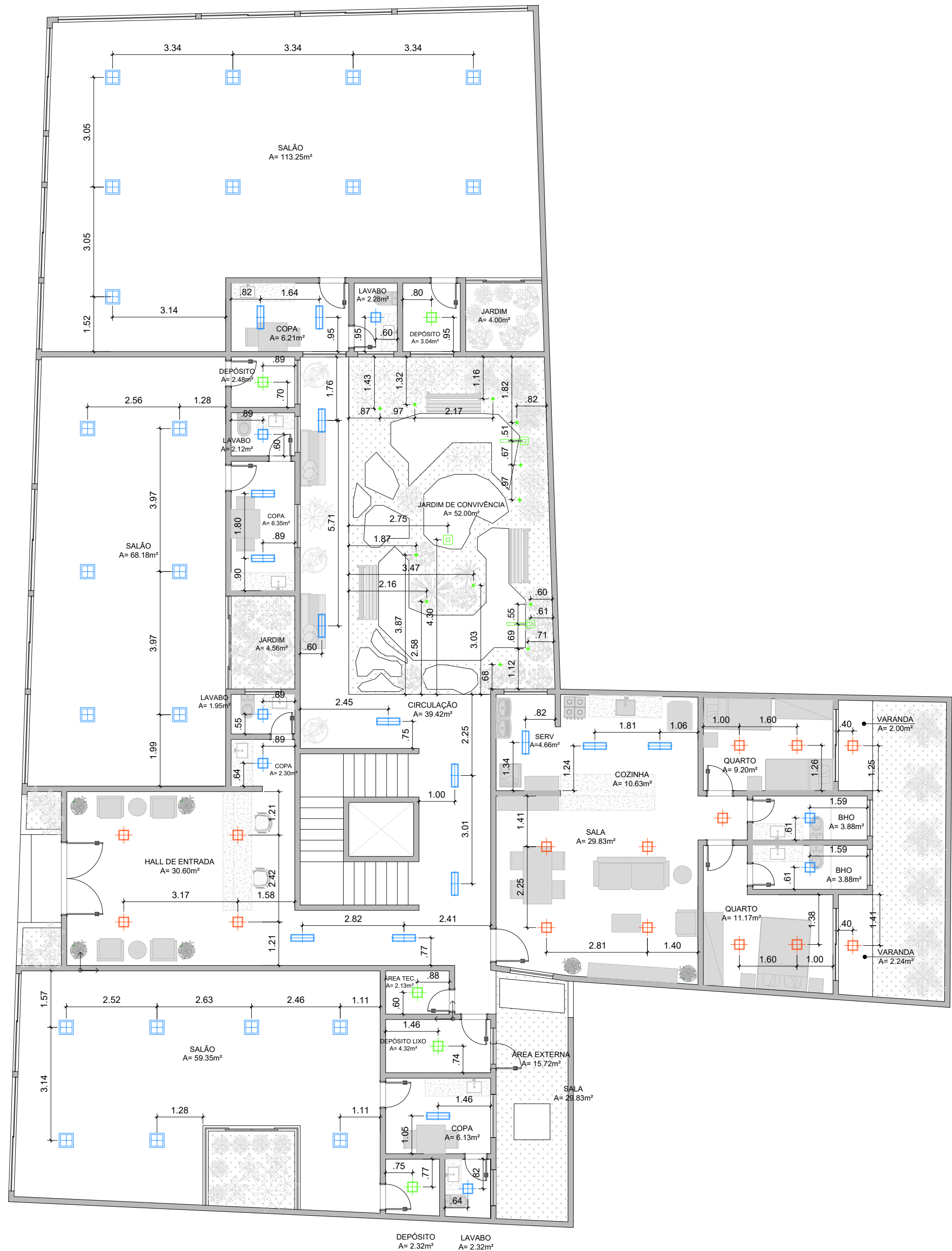
PONTOS ELÉTRICOS PAV. TIPO ESC.: 1/100
