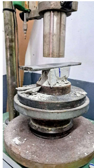
Figura 3 - Realização do ensaio de compressão - Brasil, 2025.
