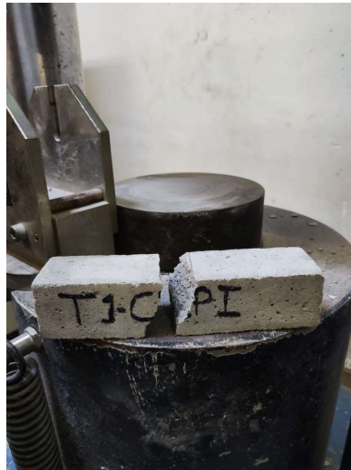
Figura 2 - Corpo de prova após ensaio de tração à flexão - Brasil, 2025.
