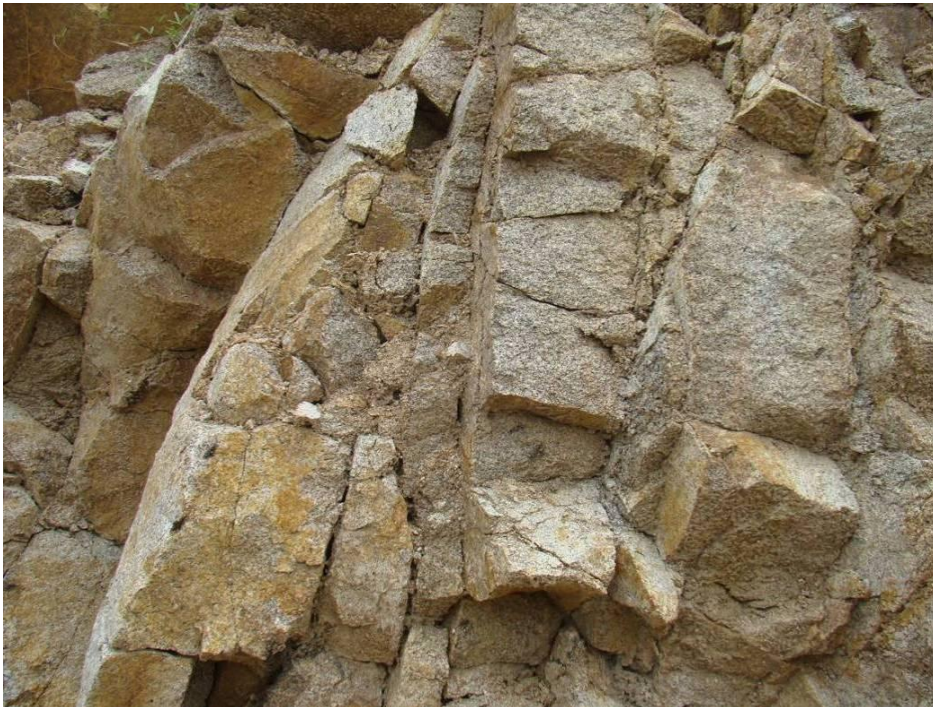
Figura 5. Detalhe da rocha granítica explorada na área. O corpo está bastante fraturado, inviabilizando a produção de granito ornamental.
