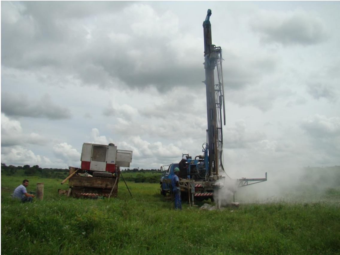
Figura 6. Operação de sondagem, para calculo de reserva.
