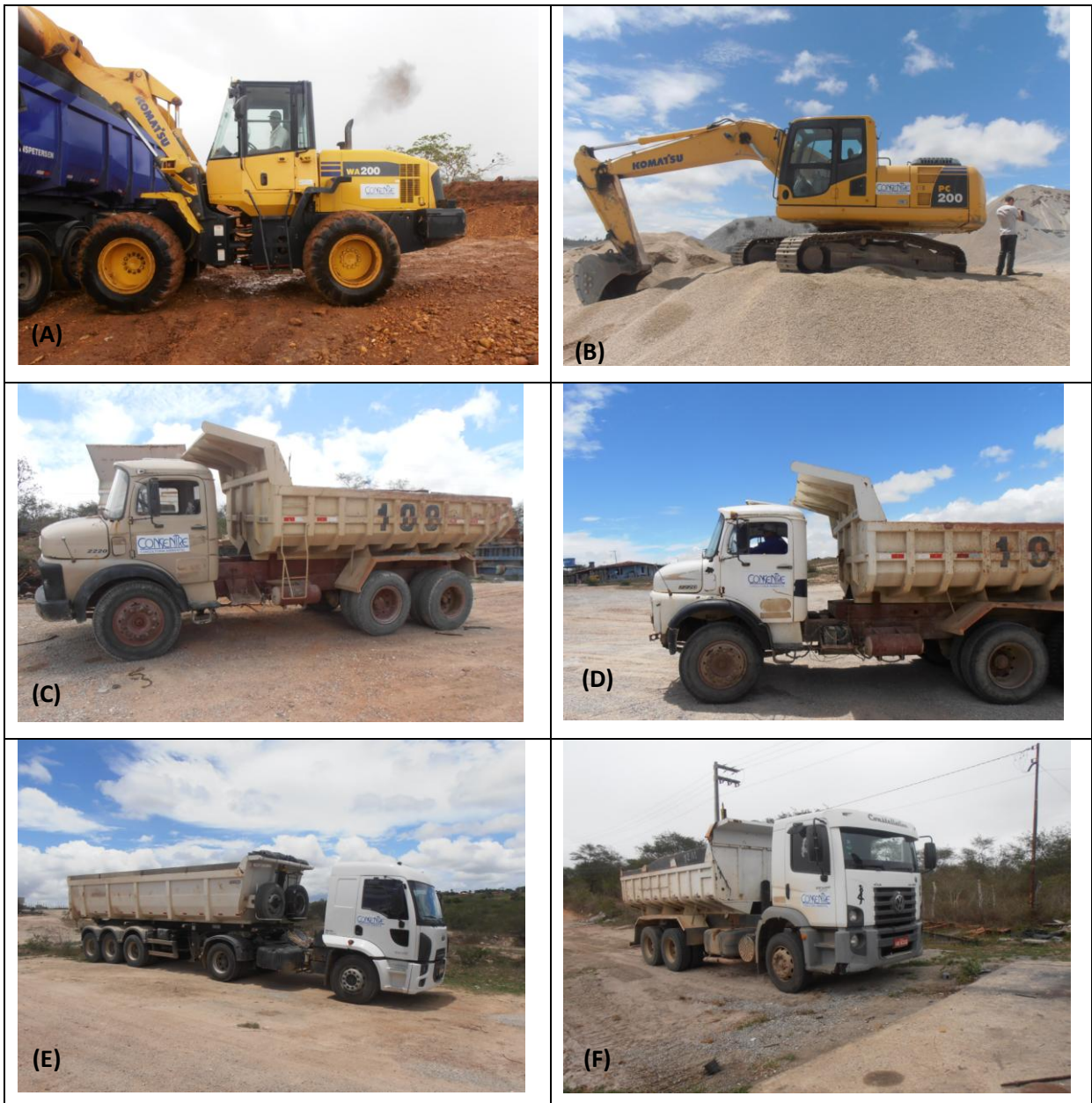
Figura 10. Fotos dos equipamentos utilizados na Pedreira São Jorge. (A) - Carregadeira sobre rodas Standar, modelo Komatsu WA-200; (B) Escavadeira hidráulica, modelo Komatsu PC-200; (C e D) - Caminhões basculantes, modelo Mercedes-Benz; (E) - Carreta basculante modelo Ford Cargo; (F) - Caminhão basculante modelo Ford Cargo 2428.
