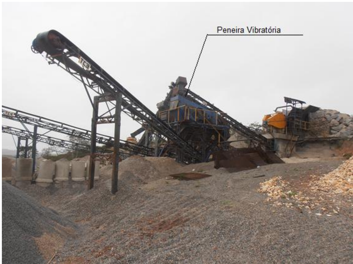
Figura 20. Central de Britagem, com destaque para o conjunto de Peneiras Vibratórias.
