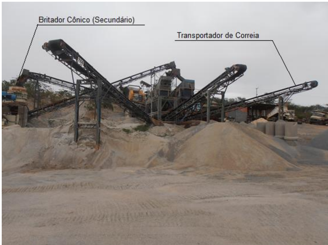
Figura 21. Central da britagem, com destaque para o Britador Cônico e as correias transportadoras.
