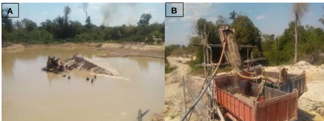
Figura 1 - Processo de extração de areia no município de Redenção-PA. A - Extração feita por cava submersa; B - Lançamento direto de areia em caçamba.
