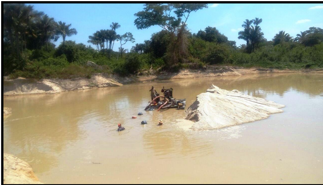
Figura 11 - Extração de areia em cava submersa em Redenção/PA, indicando poluição dos recursos hídricos.
