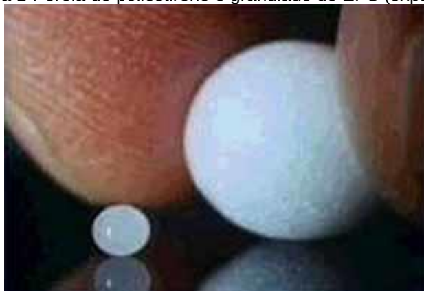
Figura 1-Pérola de poliestireno e granulado de EPS (expansão)
