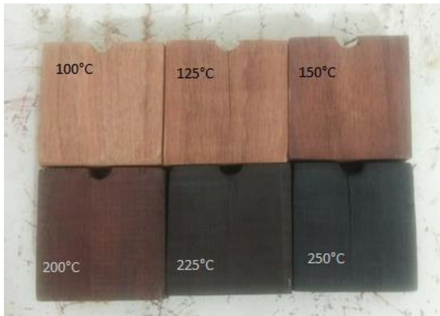
Figura 23 - Alteração dos corpos de prova de 100 °C a 250 °C, respectivamente.
