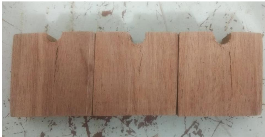
Figura 25 - Falhas de esmagamento e fendilhamento em amostras em temperatura ambiente.
