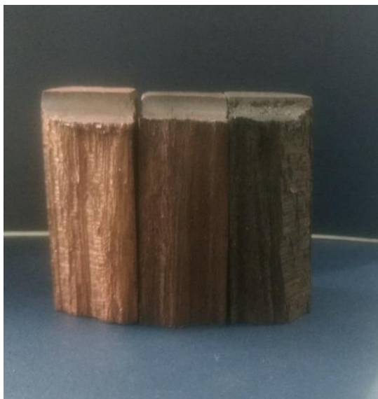
Figura 24 - Coloração interna dos corpos de prova de 200 °C a 250 °C.
