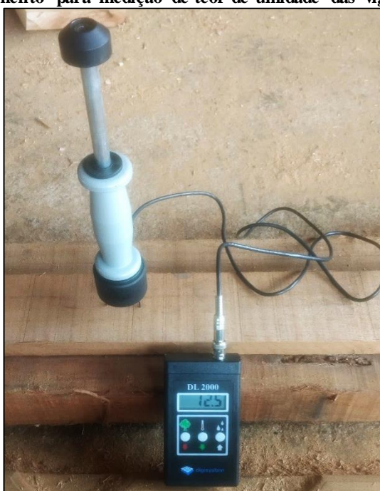
Figura 15 - Equipamento para medição de teor de umidade das vigas e madeira usada.
