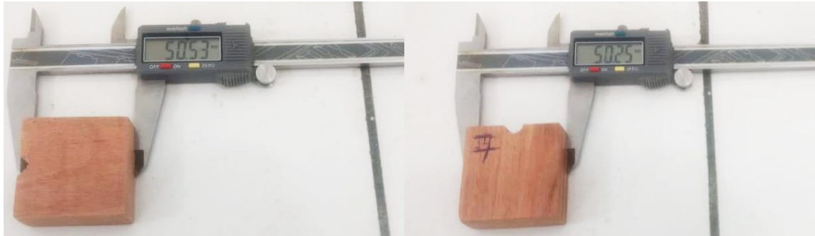
Figura 18 - Medição das amostras com paquímetro digital.
