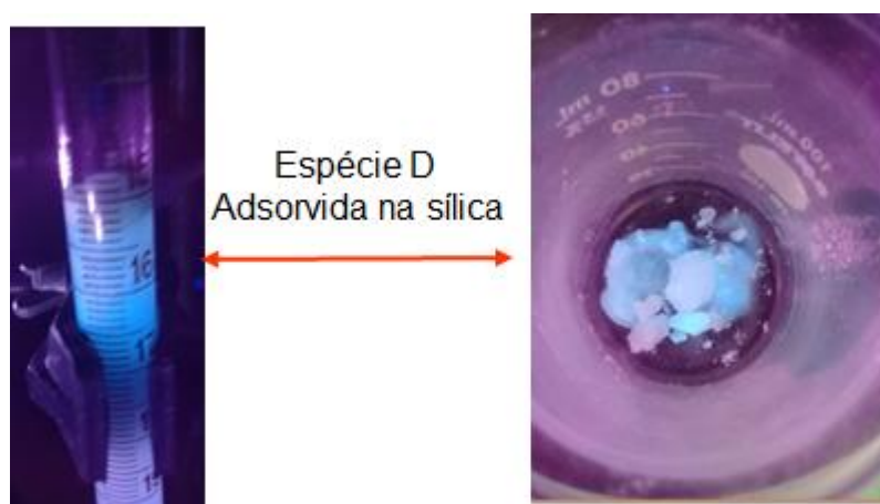
Figura 20. Cromatografia em coluna empacotada com sílica gel e forte adsorção da espécie D na sílica.
