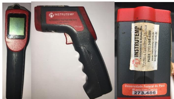
Figura 34 – Termômetro infravermelho utilizado para medir as temperaturas dos Protótipos.
