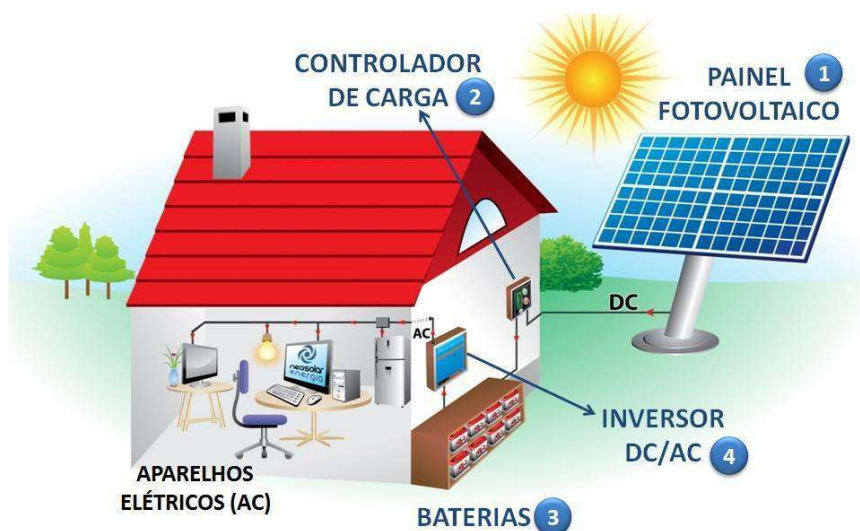
Figura 2 – Sistema fotovoltaico off-grid
