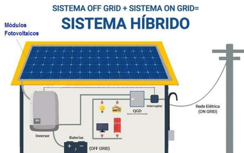
Figura 3 – Sistema fotovoltaico híbrido
