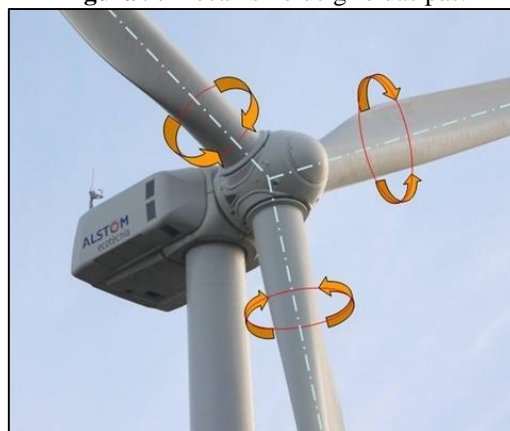
Figura 9. Mecanismo de giro das pás.
