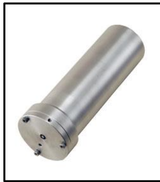
Figura 10- Sensor de pressão utilizado para a coleta mensais de dados de onda em uma praia estuarina, no estuário do rio Pará, de 2017 a 2018. Fonte: Google imagens.
