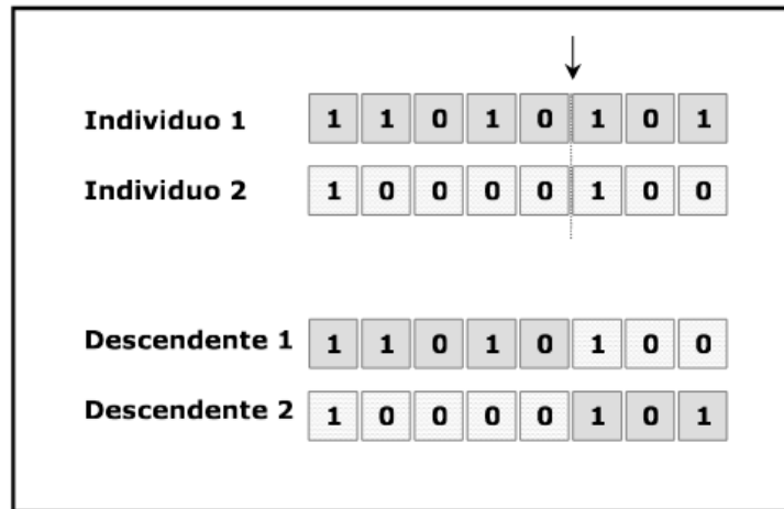
Figura 19 – Esquema da recombinação (POZO et al., 2005)
