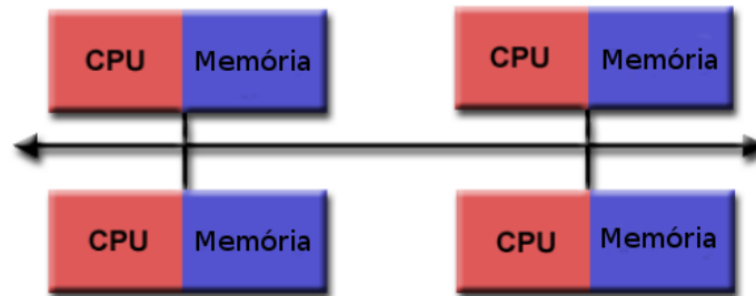
Figura 6 – Configuração de memória distribuída (KIESSLING, 2009)
