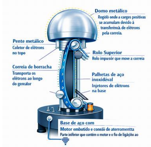
Figura 2: Processo de funcionamento do gerador e as trocas de cargas e seus componentes.
