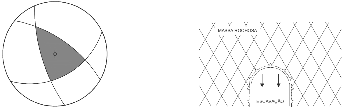
RUPTURA POR QUEDA GRAVITACIONAL QUEDA DE BLOCOS
