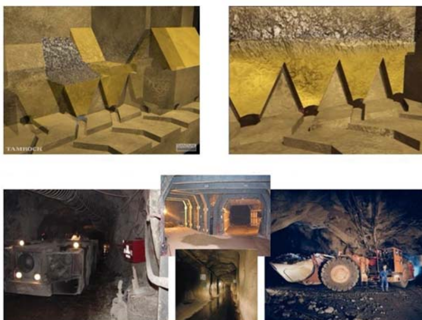
Figura 05 - Método de lavra “ block caving ”, mostrando os drawbells e os acessos aos pontos de carregamento do minério desmontado nos níveis superiores do depósito.
