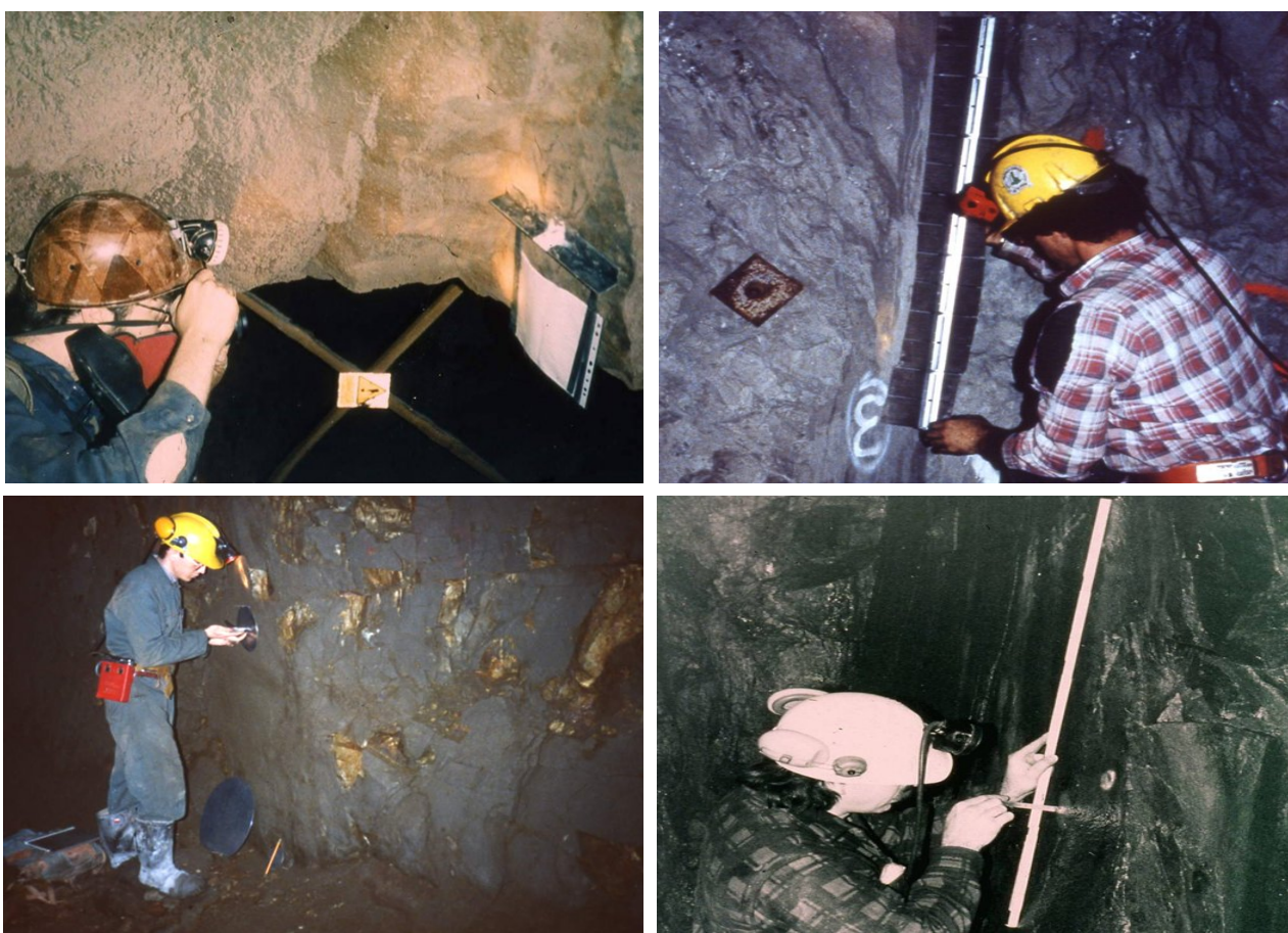
Figura 77 - Medida dos parâmetros geomecânicos do maciço rochoso ( JRC índice de rugosidade das juntas pelo método de Rengers e o pente de Barton e amplitude do perfil).
