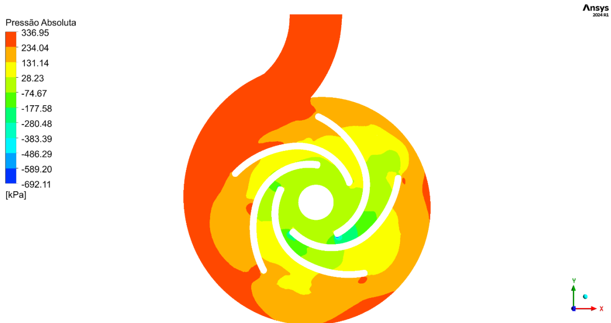
Figura 46 – Contorno da distribuição de pressão na bomba (rotor + voluta) para uma vazão de 75 m 3 /h
