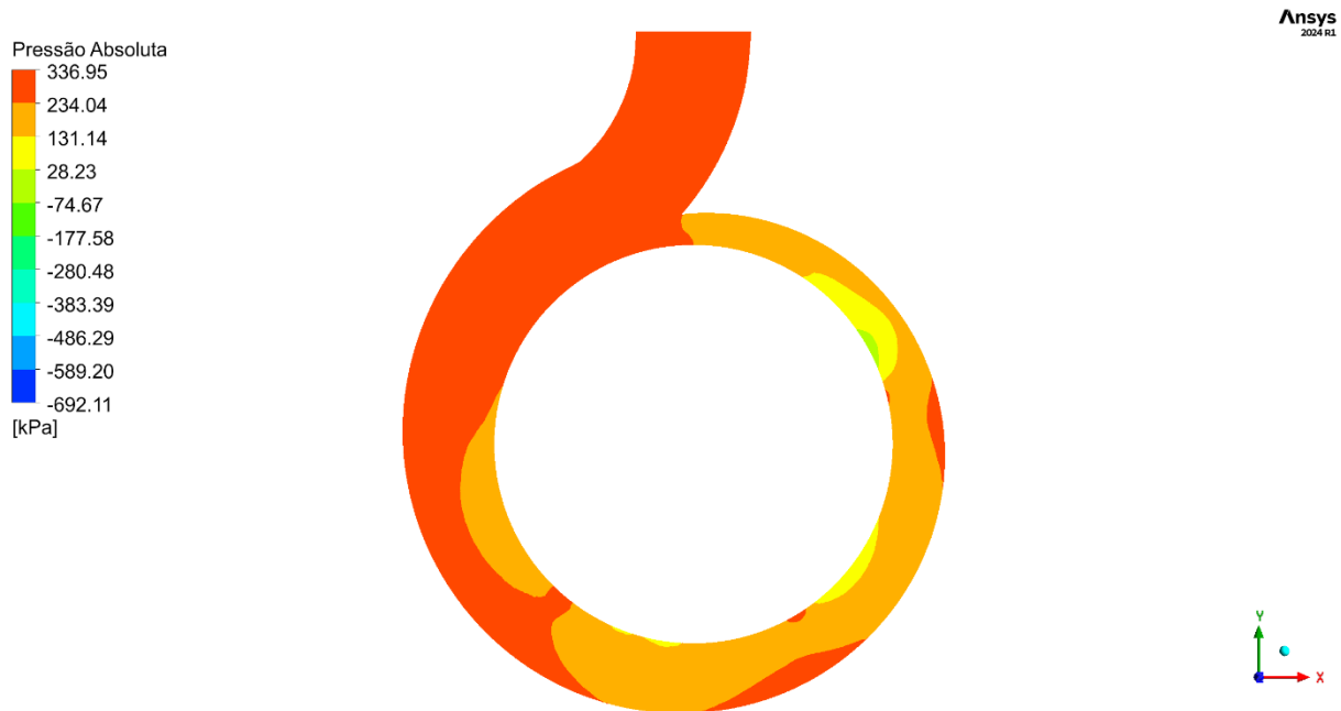
Figura 48 - Contorno da distribuição de pressão na voluta para uma vazão de 75 m 3 /h
