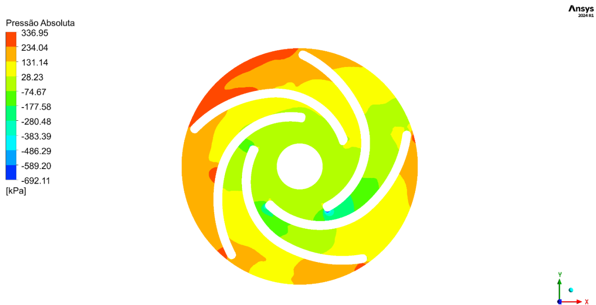
Figura 47 – Contorno da distribuição de pressão no rotor para uma vazão de 75 m 3 /h
