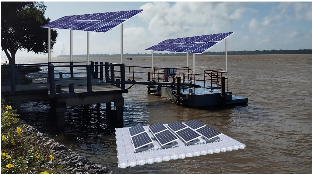
Figura 7 – Ilustração da Planta Fotovoltaica Flutuante no Rio Guamá na UFPA
