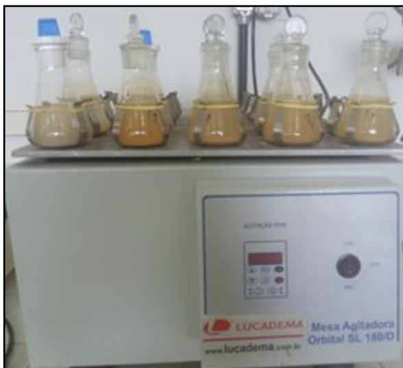
Figura 13- Ensaios com diferentes volumes de DAM e 1 g de calcário e 0,5g de HDL-500. Fonte- Do autor.
