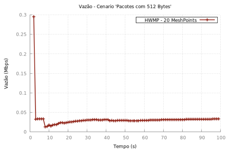
Figura 11: Taxa de Vazão do algoritmo mesh.cc , com pacotes de 512 Bytes.
