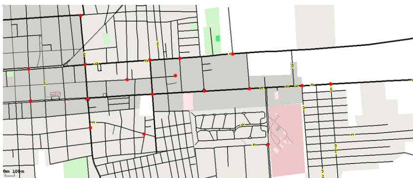
Figura 4: Representação da Rede em Malha no cenário simulado, através do SUMO .
