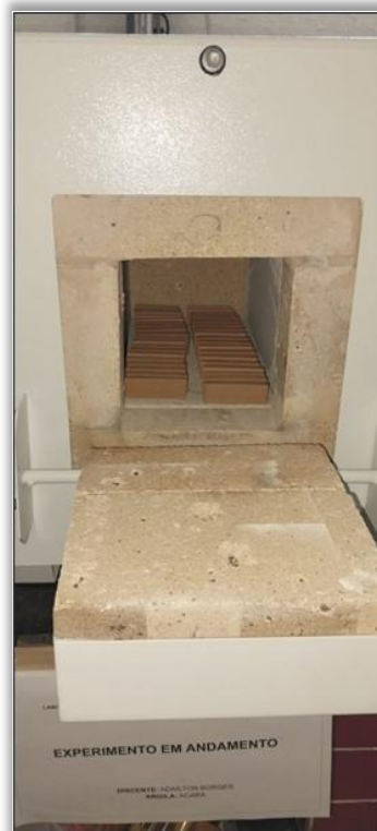
Figura 8 - Forno mufla utilizado para sinterização e disposição dos corpos de prova
