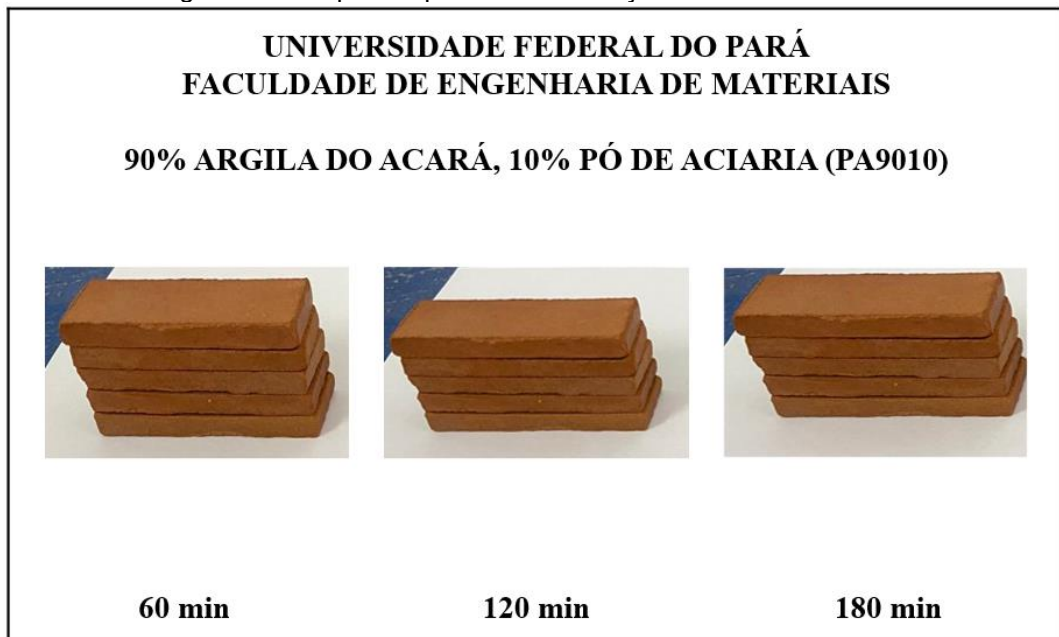
Figura 18 - Corpos de prova da formulação PA9010 sinterizados
