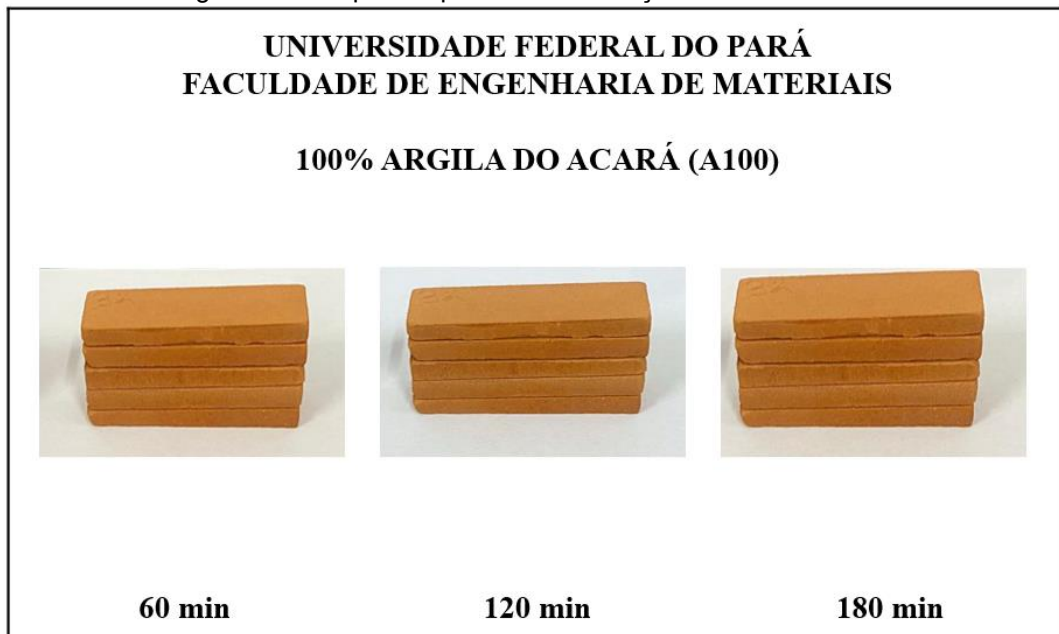
Figura 17 - Corpos de prova da formulação A100 sinterizados
