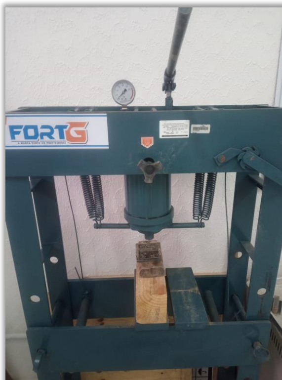
Figura 6 - Prensa hidráulica manual FORTG®, utilizada na conformação dos corpos de prova
