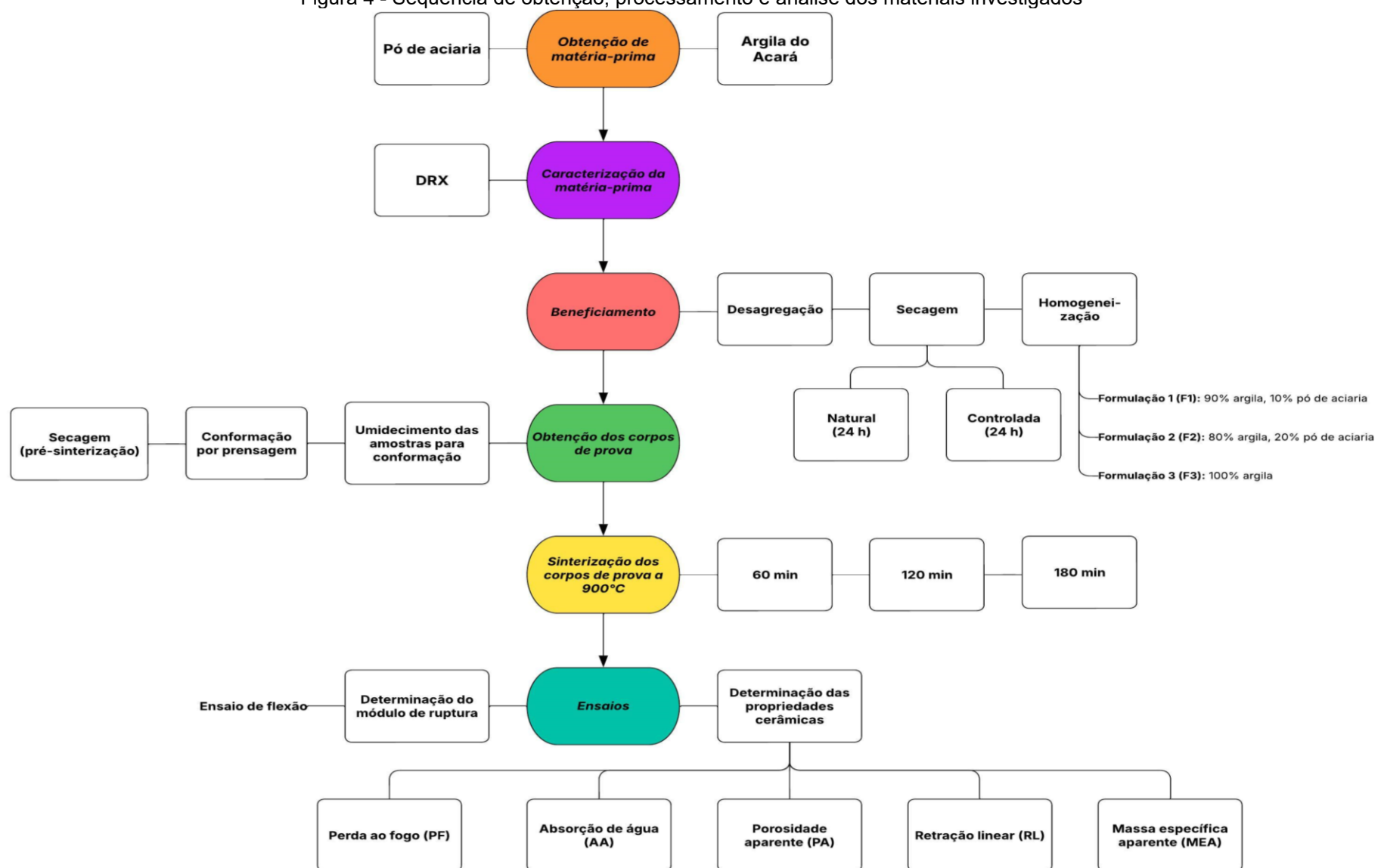
Figura 4 - Sequência de obtenção, processamento e análise dos materiais investigados
