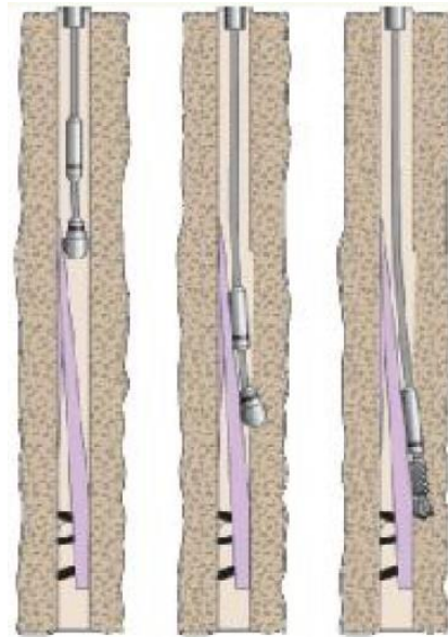
Figura 8.19: Whipstock – cunha de aço temperado alocada no poço para direcionar a perfuratriz.
