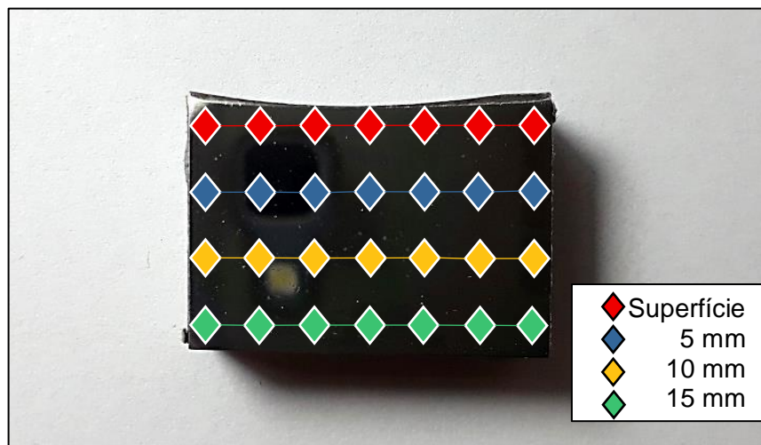
Figura 49 - Marcações do ensaio de microdureza na LC.
