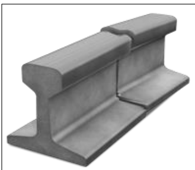
Figura 18 - Desalinhamento em trilhos.
