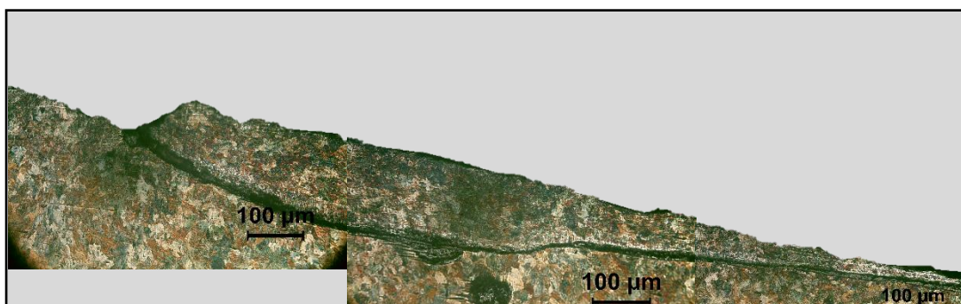
Figura 47 - Trinca com aumento de 200x.
